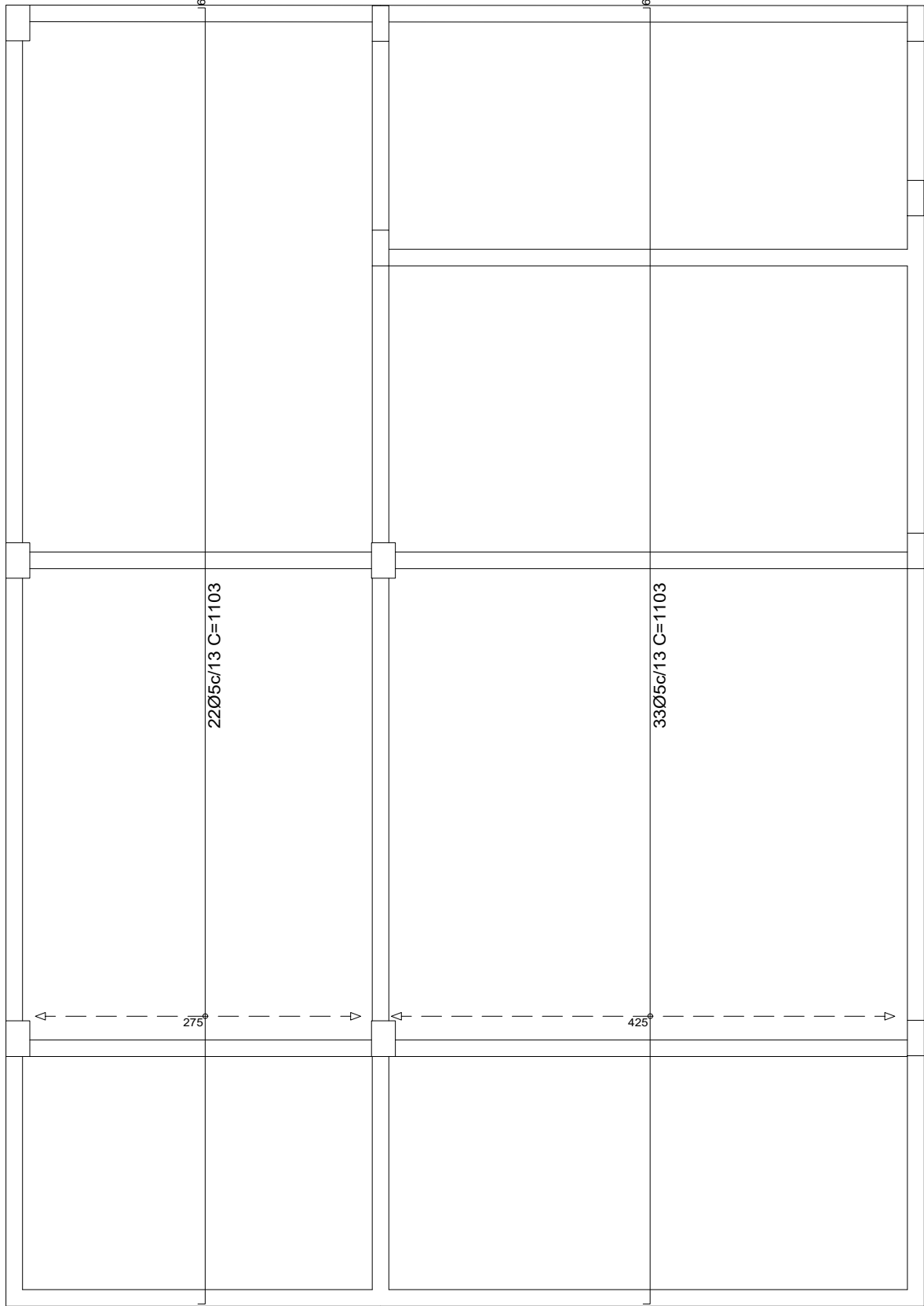
Armadura transversal inferior
