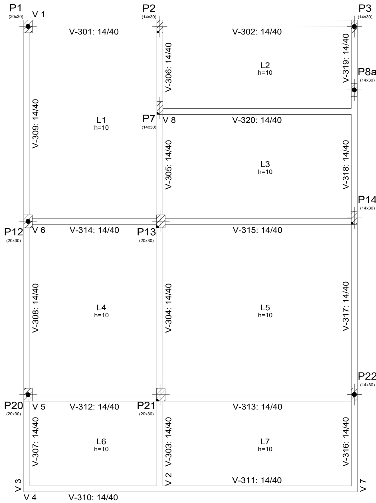
PLANTA DE FORMAS DAS VIGAS DA GAREGM (COBERTURA)
